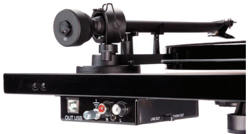
▲ Unterhalb des Tonarms sitzt die Anschlussbox mit Cinch-Buchsen, Masseklemme und – im Falle des „RecordMaster“ – USB-Schnittstelle. Wer den integrierten Phono-Amp seines Verstärkers nutzen möchte, schiebt den seitlichen Schalter auf „Line Out“. Bei „Phono Out“ aktiviert der Essential III seinen internen Entzerrer/Vorverstärker und spielt dann an jedem beliebigen Hochpegeleingang.
